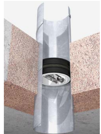
Mechanische Brandschutzklappe INLAP eingebaut in TIROTECH®-Brandschutzmörtel
