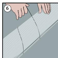
La bande autocollante sert d'aide au montage. La fixation des coquilles s'effectue à l'aide d'un fil de fer. Pour des raisons esthétiques, le fil de fer peut être recouvert ensuite par une bande autocollante.
