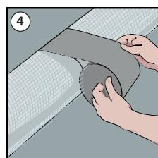
Nettoyer les zones de jointure, recouvrir de la bande autocollante adaptée.
