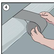
Stosstellen reinigen, mit passendem Selbstklebeband überkleben.
