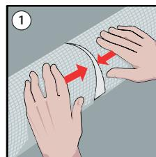
Couper les coquilles à la mesure désirée et les mettre bout à bout. Entailler où nécessaire et ajuster.
