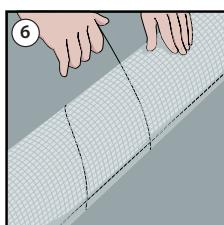
Der Selbstklebestreifen dient als Montagehilfe. Eine Sicherung der Schalen erfolgt mit Bindedraht. Aus optischen Gründen kann der Bindedraht nachträglich mit Selbstklebeband überklebt werden.
